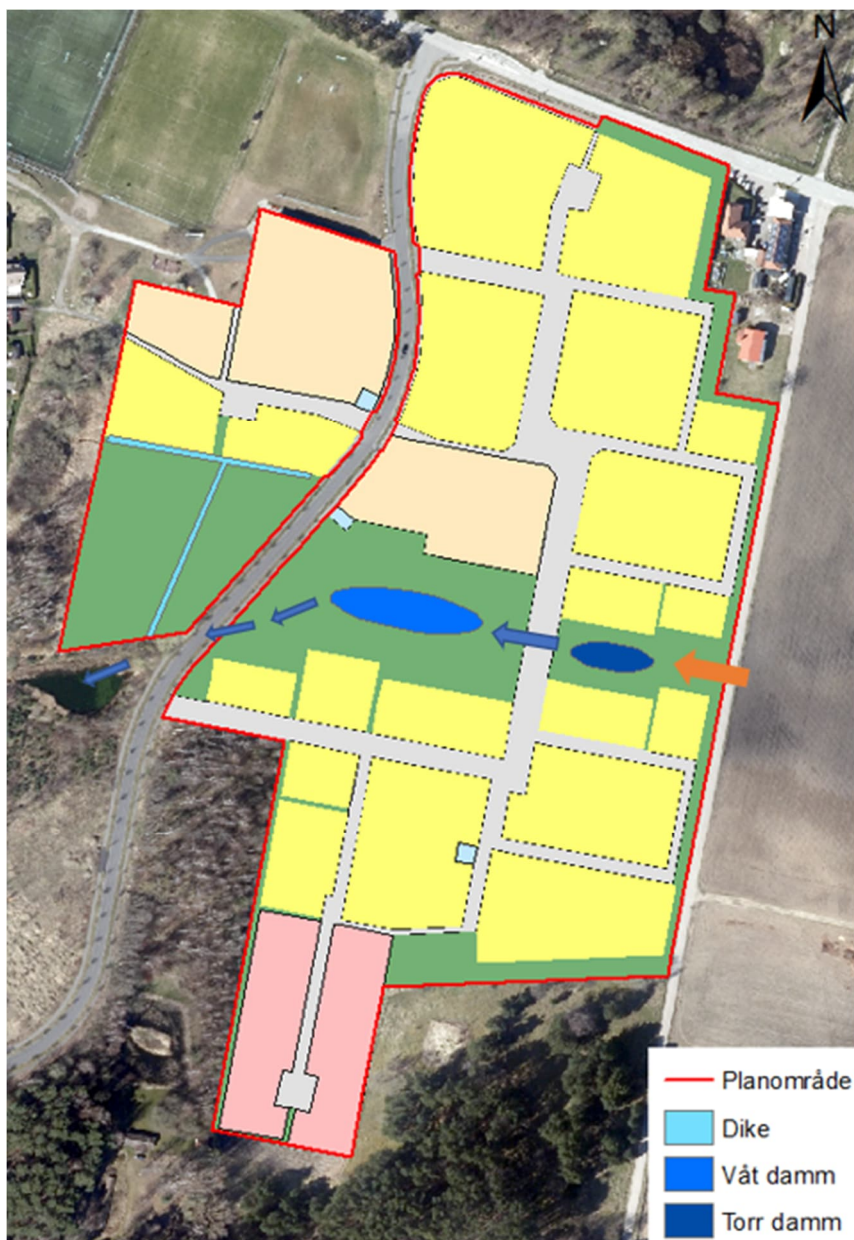
Figur 14. Illustration av lösningförslag för dagvattenhantering. Fördröjningsdamm är ej skalendig utan endast en illustration. Österifrån ansluts befintlig dikesledning (orange pil).
