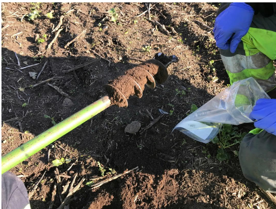
Figur 5. Ytlig jordprovtagning uttaget med handborr inom den norra delen av planområdet. Jordprovet avser mullhaltig sand, och utgör delprov till samlingsprov 20W22.
