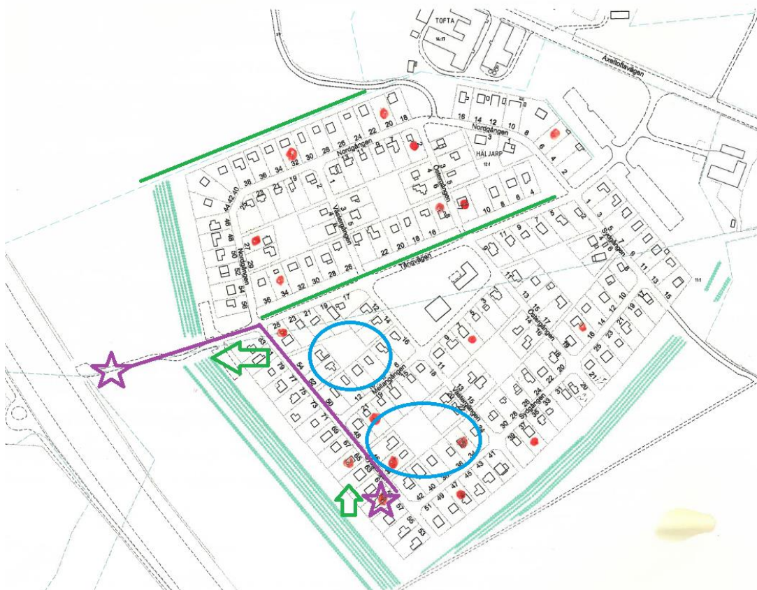
Figur 16. Övergripande åtgärdsförslag med avseende på öppen dagvattenhantering och pumpstationer för dag- och dräneringsvatten inom Axeltofta.
