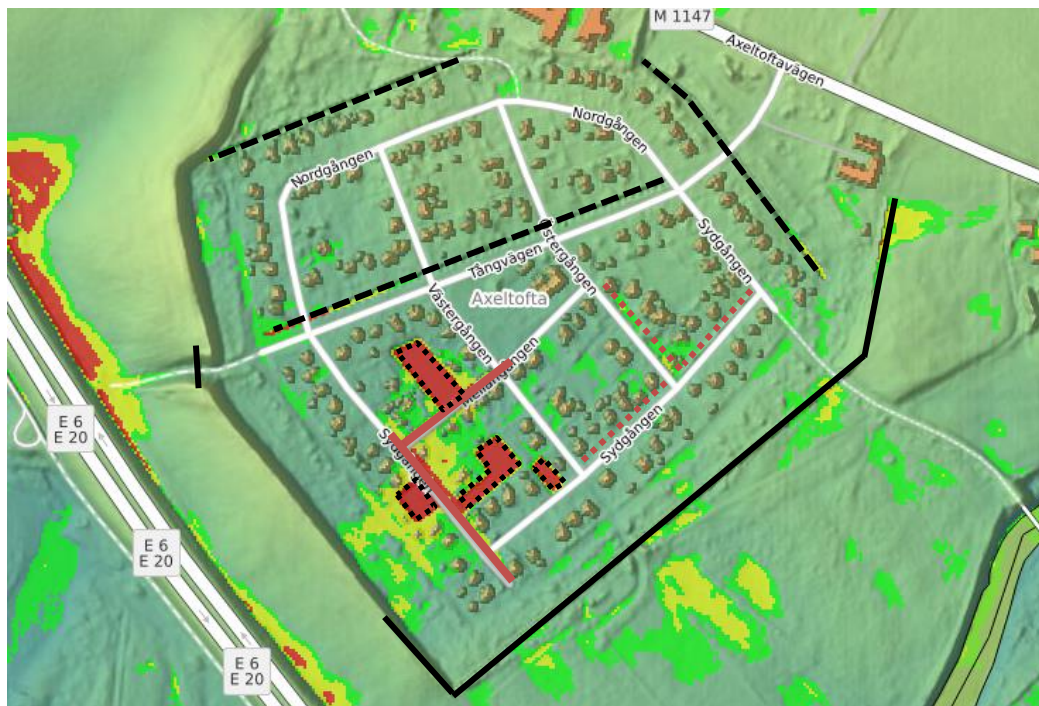
Figur 22. Skyfallssimulering med föreslagen vall såväl som med skyfallsåtgärder i form av fyra översvämningsytor, tre svackdiken, kantsten och nedsänkta vägar. Tre bostäder har tagits bort för att göra plats för översvämningsytor (alternativ 5).
