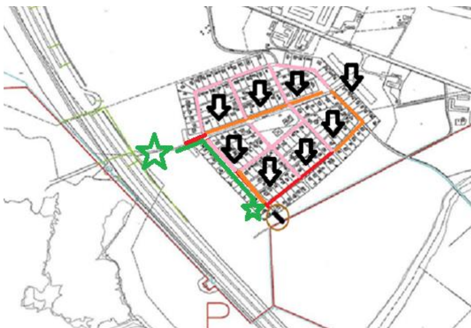
Figur 10. Riktning på flödet samt föreslagna dimensionering av dagvattensystemet i alternativ 2. Rosa sträckor har dimensionen 225mm, orange har 500mm och röd har 800mm. Gröna stjärnor och grön linje visar pumpstationer respektive överföringsledning inom området.
