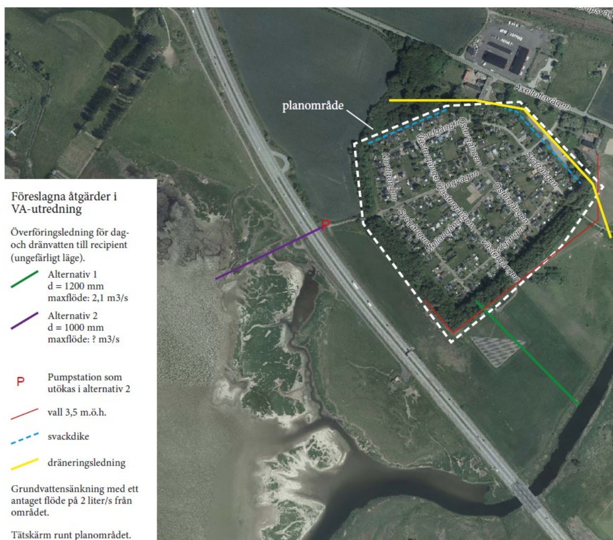
Figur 5. Föreslagna åtgärder för Axeltofta gällande skyddsvallning och pumpning av vatten (karta från Landskrona kommun).
