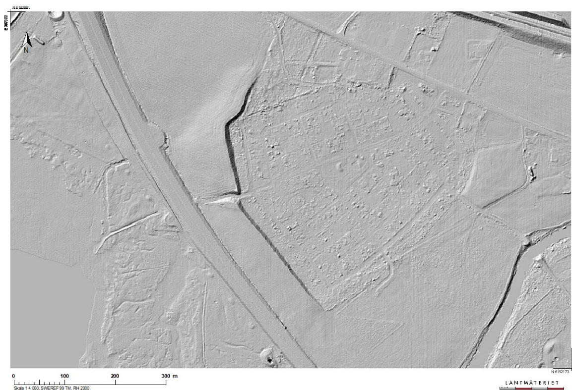
Figur 4. Lantmäteriets terrängskuggningskarta visar den befintliga vallen i väster. Inga öppna diken syns inom området utan dagvattnet rinner i ledningar ut under motorvägen.
