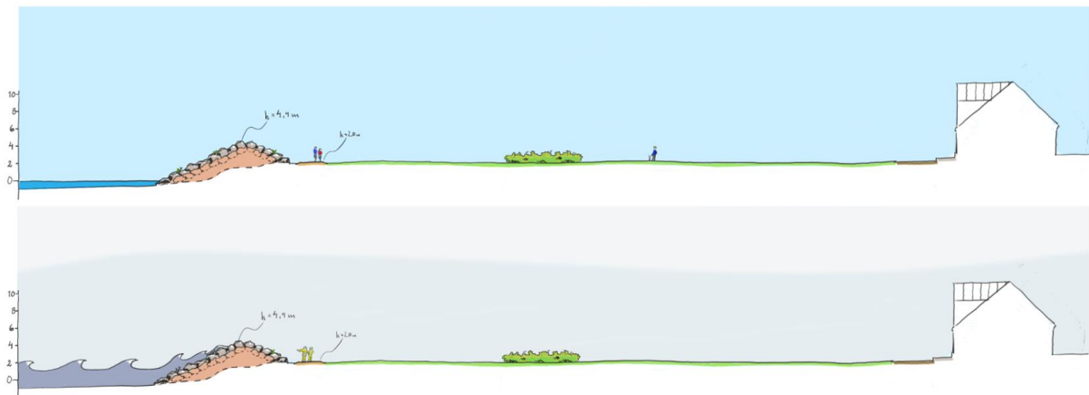
Figur 7-9 Illustration över landskapsbilden vid skydd utmed kustlinjen som utgörs av en stenskoning i nära anslutning till havet.
