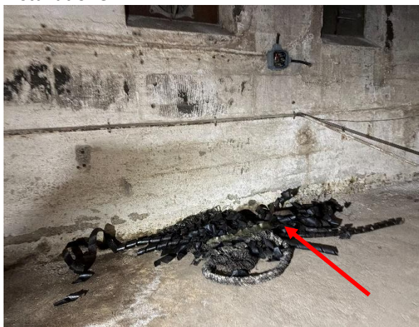
Foto 11. Svart papp förekommer löst på källarplan, se röd pil. Papp innehåller PAH-16 (43 800 mg/kg) överskridande GvFA, verifierat via prov 260428:30.
