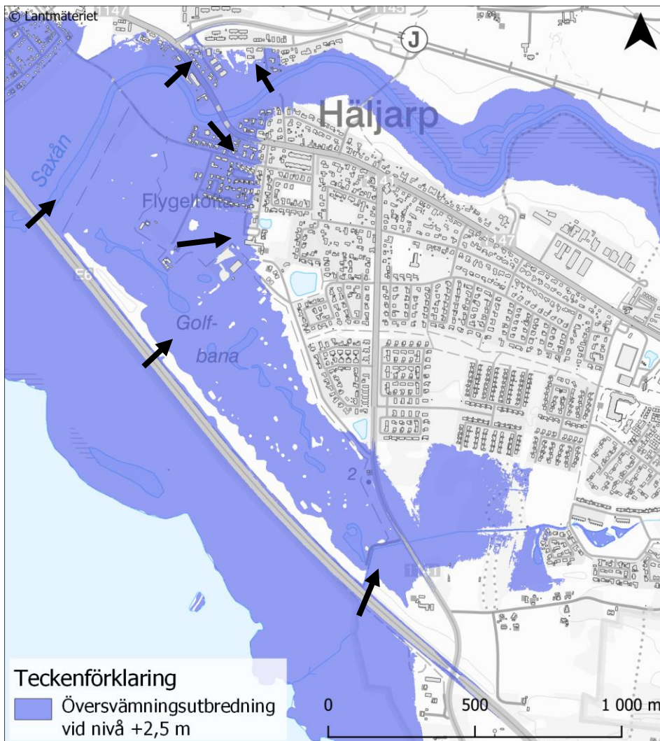
Figur 6-8 Översvämning vid vattennivå +2,5 m (RH2000), motsvarande ett 200-årshögvatten cirka år 2075. Inströmningsvägar är markerade med pilar.
