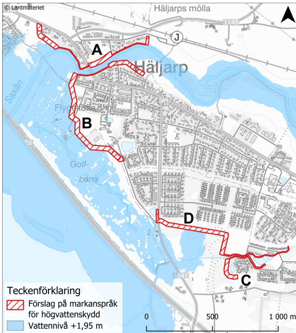
Figur 8-1 Föreslagna skyddssträckor (enligt alternativ 1) kring bebyggelsen i Häljarp samt vattenutbredning vid nivå +1,95 m, motsvarande medelvattenytan år 2150. De olika skyddssträckorna benämns A-D.
