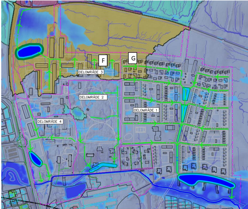
Figur 8. Rinnpilar för föreslagna sekundära avrinningsvägar inom planområdet. Planskiss daterad 2021-02-23 är pålagd för lättare orientering, men kan innehålla inaktuell information. Rosa linjer avgränsar delområden.
