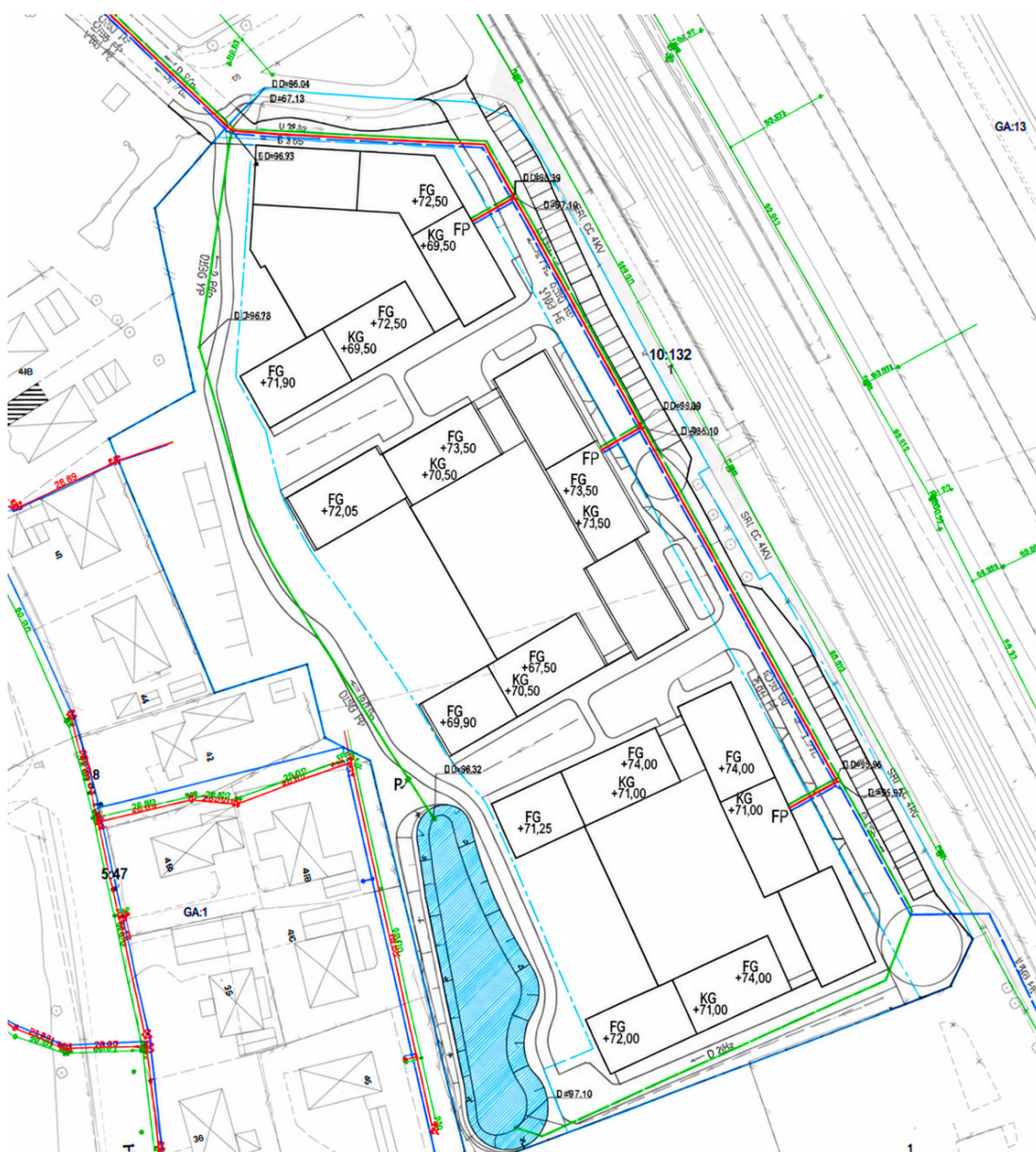
Figur 28: Principskiss över möjlig utbyggnad av VA system inom planområdet( se avsnitt nästa sida)
